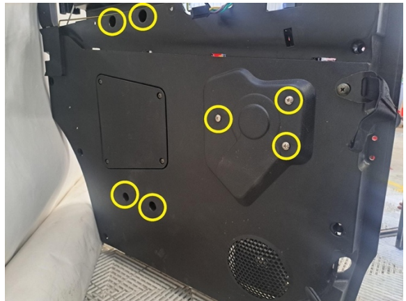
Irrota lasinnostimen ja lasinnostimen moottorin kiinnitysruuvit. (ristipäämeisseli ph2). Kannattele lasinnostinta samalla kun irrota lasinnostimen kiinnitysruuveja, ettei koko kokonaisuus tipu alas.
