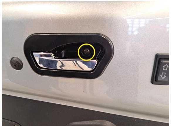
Irrota oven sisäpuolen avauskahvan kiinnitysruuvit. (ristipäämeisseli ph2).
