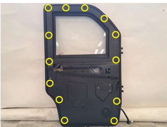
Irrota kiinnitysruuviin suojakorkit. (pieni talttameisseli).
